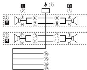
Выполните данные подключения при использовании сабвуфера без дополнительного усилителя.
